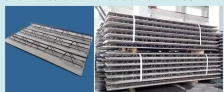
钢筋桁架与预制混凝土的完美结合是该产品最突出的特点，相较于其他形式的装配式楼板产品，混凝土底模可以作为施工模板，浇筑完成后作为结构受力层。钢筋桁架既是施工支撑，亦为楼板配筋。楼板厚度最薄可以做到100mm，更多地利用空间，既可以减少材料的浪费，又大大降低了人工消耗，从而降低项目工程造价。
